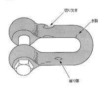
当り傷、切り欠き、き裂が あるものはグラインダ等で なめらかに削りとり、その 深さが元の寸法の5%を こえるものは廃却してくだ さい。
